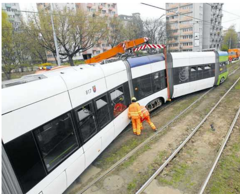
• Al. Wyzwolenia. Wykolejony na uszkodzonym torowisku swing FOT. CEZARY ASZKIEŁOWICZ / AG
